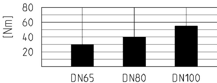
Anzugsdrehmoment der Schrauben bei Flanschverbindungen
