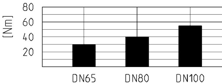
Anzugsdrehmoment der Schrauben bei Flanschverbindungen
