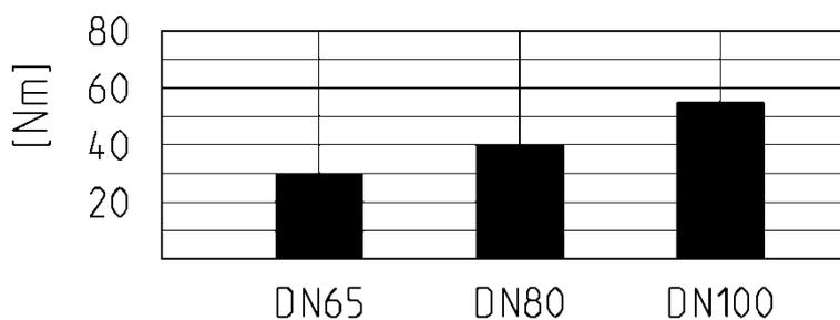
Anzugsdrehmoment der Schrauben bei Flanschverbindungen
